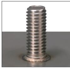
Kleiner, gleichmäßiger spritzerfreier Schweißwulst Small, even and spatter-free weld bead
